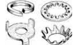
! Pruebas independientes han demostrado que algunos tipos de arandela se aflojan cuando se exponen a cargas dinámicas. Todas las selecciones de arandela deben ser adecuadas a la aplicación, el medio ambiente y la criticidad de la conexión.
