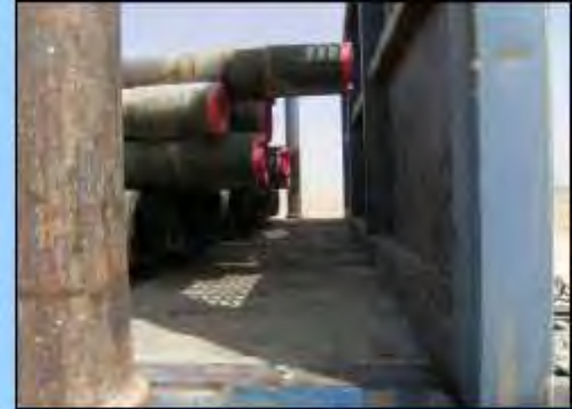
Pipe work NOT set to head board لم تصل حمولة الأنابيب إلى اللوحة الأمامية
